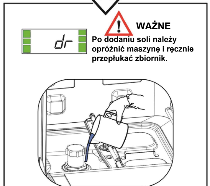
Ręczne płukanie zbiornika
