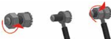
Obrázok 3. Pripojenie zariadenia k inštalácii na vyrovnávanie elektrických potenciálov.
