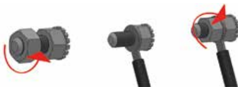
Bild 3. Der Anschluss des Gerätes an die Potentialausgleichsanlage
