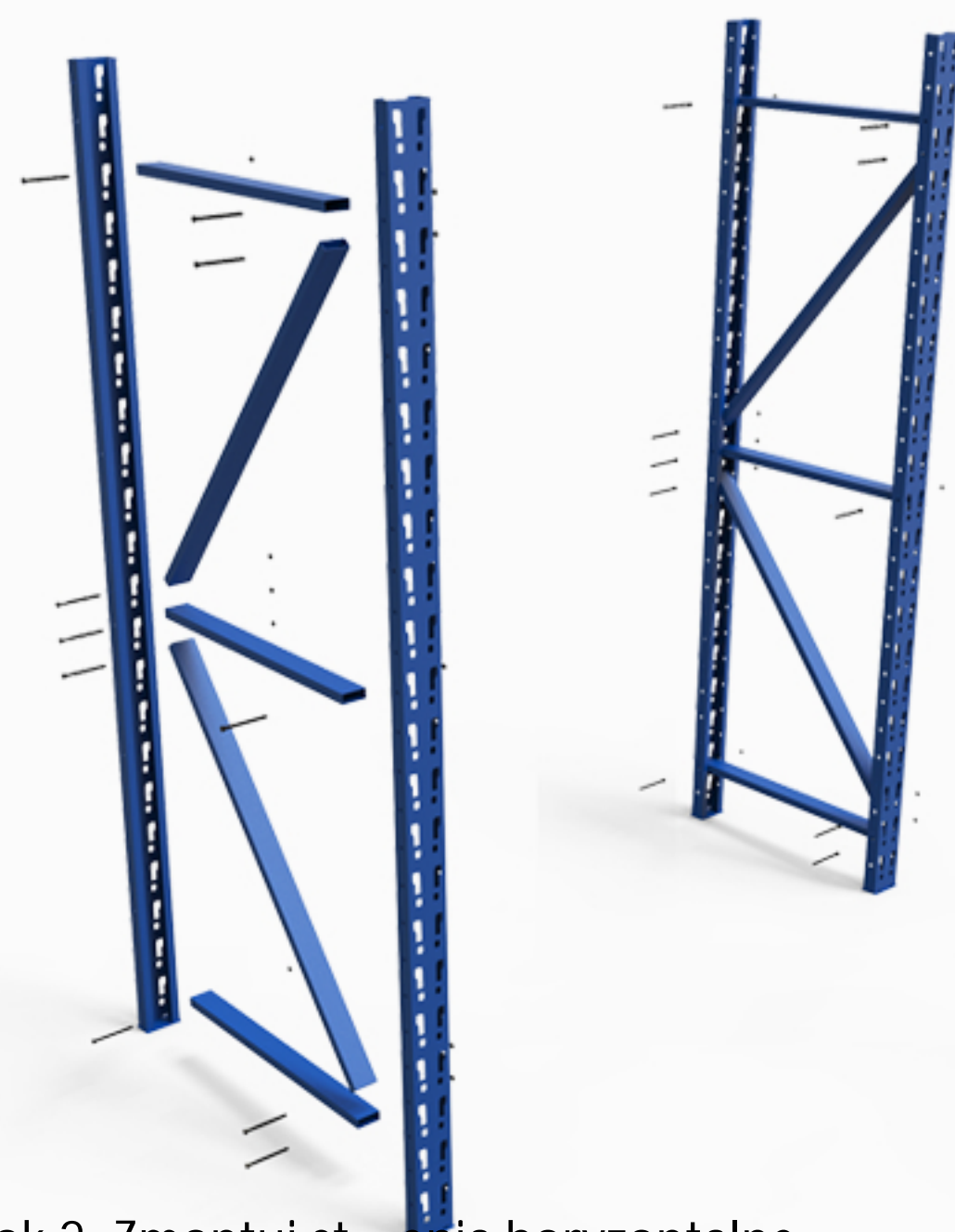
Krok 2: Zmontuj słupki i elementy poziome oraz diagonalne ze słupkami za pomocą rur i nakrętek.
